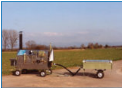
MS 200: Dämpfzeit für 0,5 m 3 30 min
